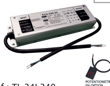
Ref : TL 24I 240 Alimentation 24Vdc ON/OFF DIM 0-1/10V Puissance max : 240W Dimensions : 260x70x38mm
