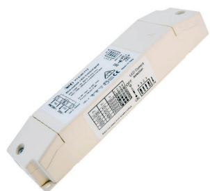
Ref : TL DALI 36 Alimentation 24Vdc ON/OFF DIM DALI Puissance max : 36W Dimensions : 164x41x35mm
