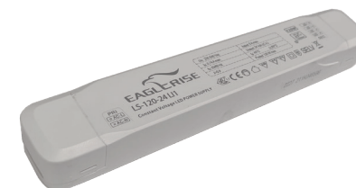
Ref : TL 24 120 Alimentation 24Vdc ON/OFF Puissance max : 120W Dimensions : 268x45x30
